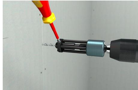
Zentrierbohrer mit seitlicher Befestigungsschraube fixieren.
