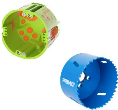
Geräteverbindungsdose für die Hohlwandinstallation, Durchmesser: 74 mm, Tiefe: 62 mm, 2x3 Schraubdomme, 6 Kabeleinführungen, 2 Rohreinführungen bis M25, SCS-Verbindungstechnik für Mehrfachkombinationen im Normabstand von 71 mm, einfaches Durchverdrahten ohne Verbindungsstutzen durch großflächige Verbindungsmembran mit Cable-Plopp-Technik, geeignet für Plattenstärken von 0-37 mm, Einbau vorverdrahteter Geräte durch das Austrennen des Verbindungssteigs möglich.
