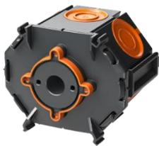
Membrandose M2 35 – Geräteverbindungs-, Flügelbeton- und M32 Großrohrdose. (35 mm Leuchtauslassdeckel) aus Kunststoff nach VDE 0606-1 – im Ortbeton.
