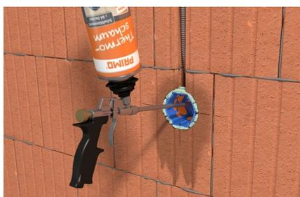
Dose einsetzen, Schaum einsprühen = in wenigen Sekunden wärmebrückenfrei und luftdicht installiert.
