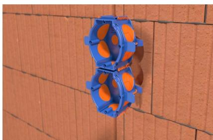
Wird die Wand nicht verputzt, Putzanschlag abbrechen und Dose bündig ins Bohrloch einsetzen..
