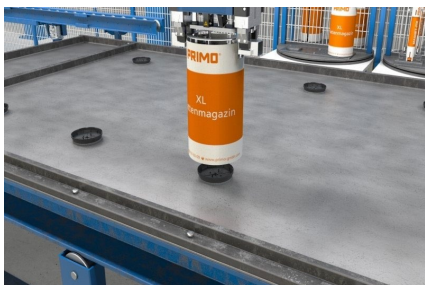
Variante 2: Automatisierte Montage mit Magnetbefestigung. Frontteile werden automatisch auf dem Schaltisch positioniert.
