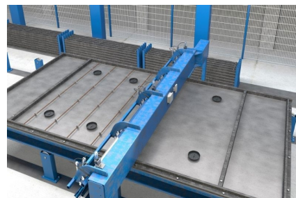
Bewehrung wird durch ein Quereisenautomat eingebracht.
