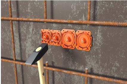
Wandmontage: Frontteil auf Schalung nageln. Integrierte Nagelfixierung ermöglicht eine einfache Montage. Das Frontteil lässt sich durch das Stecksystem fest mit weiteren Krümmern verbinden.
