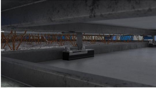
Magnete fixieren die erste Betonschale auf dem zweiten Schaltisch.
