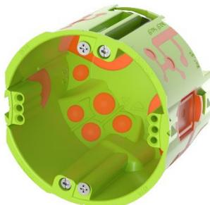
Geräteverbindungsdose für die Hohlwandinstallation, Durchmesser: 74 mm, Tiefe: 62 mm, 2x3 Schraubdomme, 6 Kabeleinführungen, 2 Rohreinführungen bis M25, SCS-Verbindungstechnik für Mehrfachkombinationen im Normabstand von 71 mm, einfaches Durchverdrahten ohne Verbindungsstutzen durch großflächige Verbindungsmembran mit Cable-Plopp-Technik, geeignet für Plattenstärken von 0-37 mm, Einbau vorverdrahteter Geräte durch das Austrennen des Verbindungsstegs möglich.
