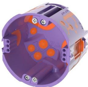
Gerätedose für die Hohlwandinstallation mit Schallschutz, Durchmesser: 74 mm, Tiefe: 49 mm, 2x3 Schraubdomes, 6 Kabeleinführungen, 2 Rohreinführungen bis M25, SCS-Verbindungstechnik für Mehrfachkombinationen im Normabstand von 71 mm, einfaches Durchverdrahten ohne Verbindungsstutzen durch großflächige Verbindungsmembran mit Cable-Plopp-Technik, geeignet für Plattenstärken von 0-37 mm, Einbau vorverdrahteter Geräte durch das Austrennen des Verbindungsstegs möglich.
