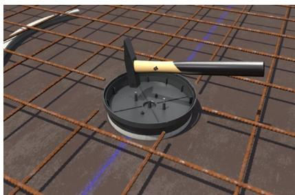
Frontteil auf die Schalung nageln. Die integrierte Nagelfixierung ermöglicht eine einfache Montage.
