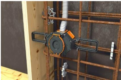
Flügel ermöglichen eine einfache Montage. Flügel mit Draht auf der Stahlarmierung befestigen.
