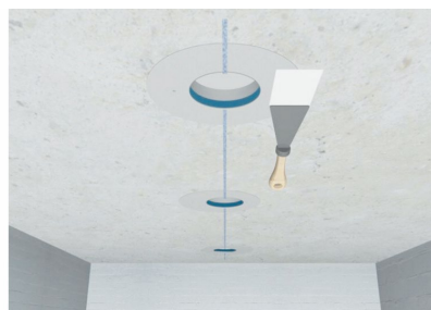
...und an die Mineralfaserplatte angespachtelt.
