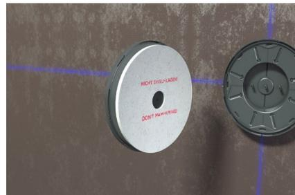
Wandmontage: Universalfrontteil auf die Schalung nageln. Die integrierte Nagelfixierung im Frontteil ermöglicht eine einfache Montage.
